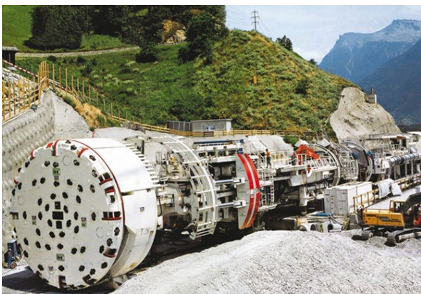
A svájci Szent Gotthard-alagút fűtőgépeit Rexroth hidraulika hajtja
